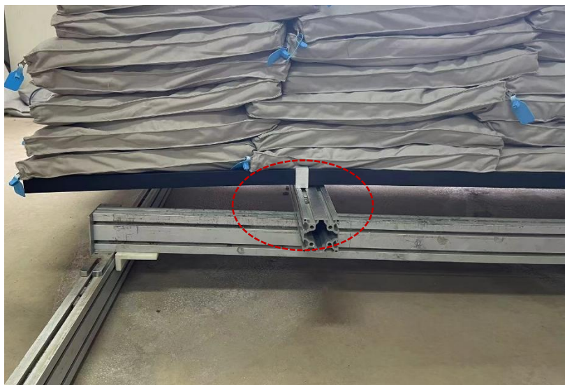
图 2.2 C 型螺栓安装实拍图
